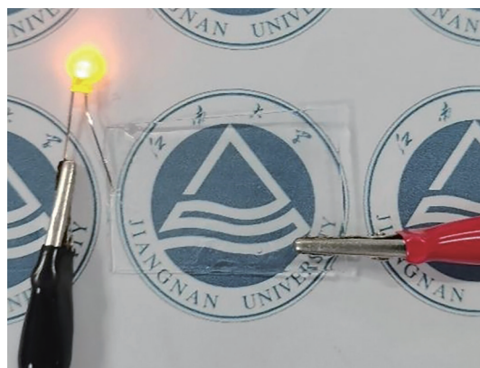
图5 PVA-LiBF 4 凝胶电解质点亮二极管
